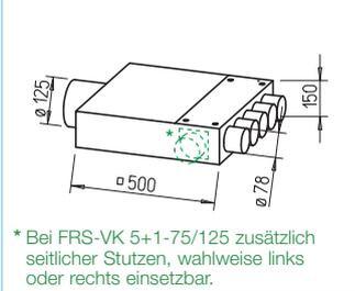
\* Bei FRS-VK 5+1-75/125 zusätzlich seitlicher Stutzen, wahlweise links oder rechts einsetzbar.
